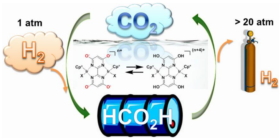
Joonis 1.6 Vesinik – energiasalvesti tööpõhimõte [1]
