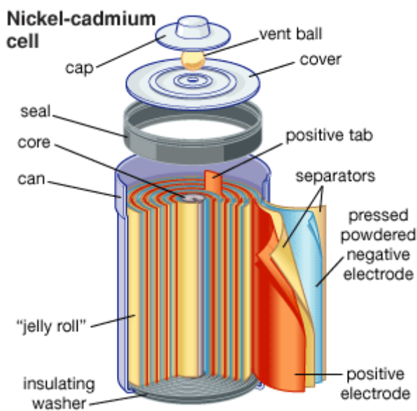
Joonis 1.9 Nikkel-kaadmiumaku tööpõhimõte [1]
