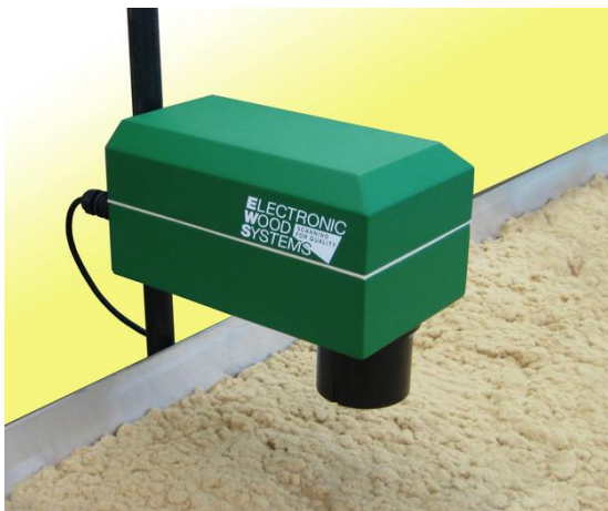
Sele 4.2. Electronic Wood Systemsi puidulaastu niiskusemõõtja MT-Scan [7]
