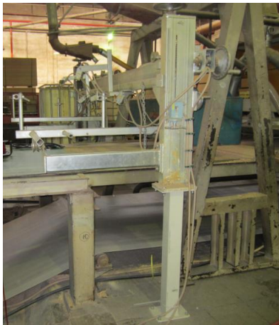
Sele 2.9. Laastumati ülemist poolt niisutav niisutusmasin paigaldatuna formeerimisliinile
