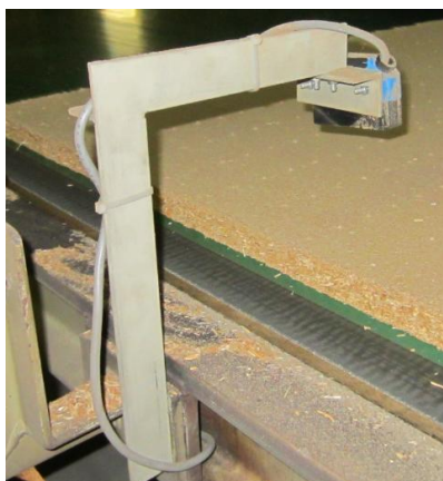
Sele 3.9. Paksuse mõõtja valmislahendus kinnitatuna formeerimisliini külge
