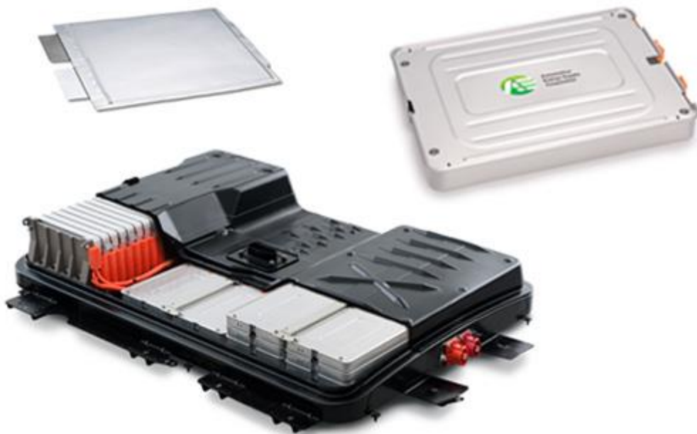
Joonis 5.1 Üleval vasakul lamineeritud aku element. Üleval paremal aku moodul, mis koosneb 4-st elemendist. All on Nissan Leafi akupakk, mis on kooste 48ksast moodulist. [16]
