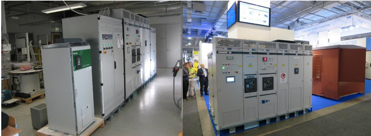
Joonis 3.4 Vasakul TTÜ ja AS Harju Elekter Teletehnika koostöös arendatud mikrovõrgu prototüüp ja paremal seesama prototüüp Elfack näitusel Rootsis, Gothenburgis, 5-8 mai 2015.
