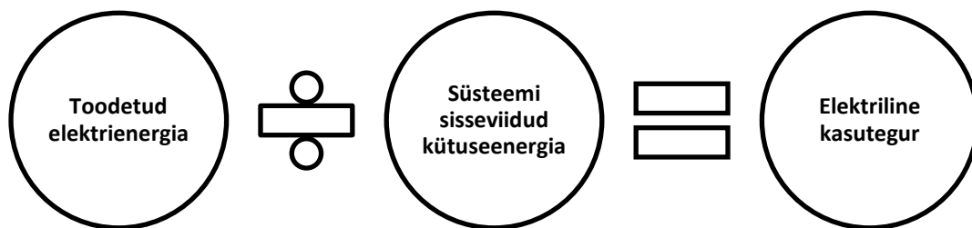
Joonis 1.2 Elektrilise kasuteguri arvutus. [23]
