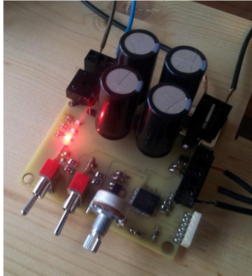
Joonis 6.2 Valminud õppemaketi elektroonikaseade Elektroonikaseade sai ühendatud ette nähtud trafoga (12 V / 3,3 A). Toide toimis nagu ette nähtud. Trafo ühendus elektroonikaseadmega on näidatud joonisel 6.3.
