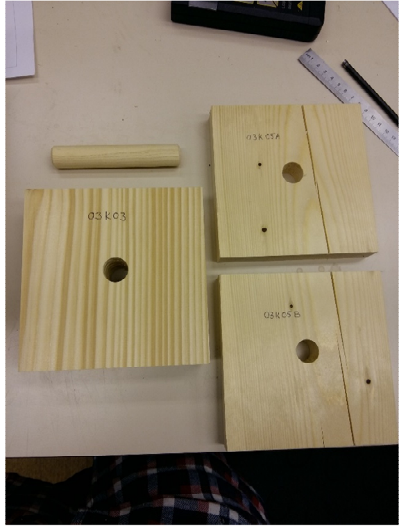
Joonis 16 Katse nr 3 detailid enne monteerimist
