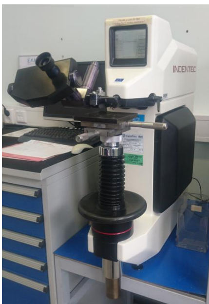
Figure 15. Hardness tester „INDENTEC“
