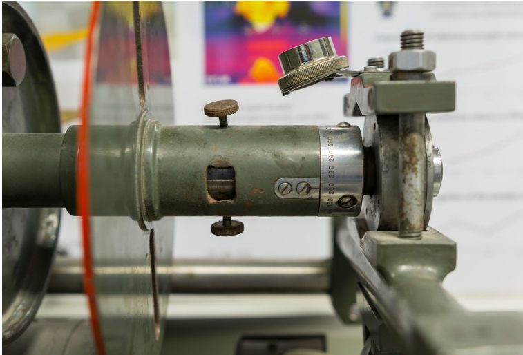
Sele 2.2 Balanseerimisseadme parempoolne ots. Foto autori poolt tehtud.
