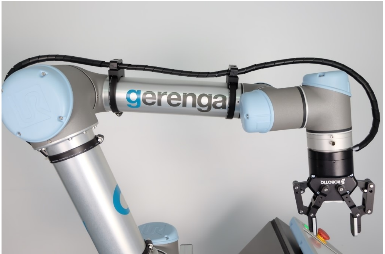
Sele 3.12 Spetsiaalsed kinnitusklambrid robotile UR5 [39]
