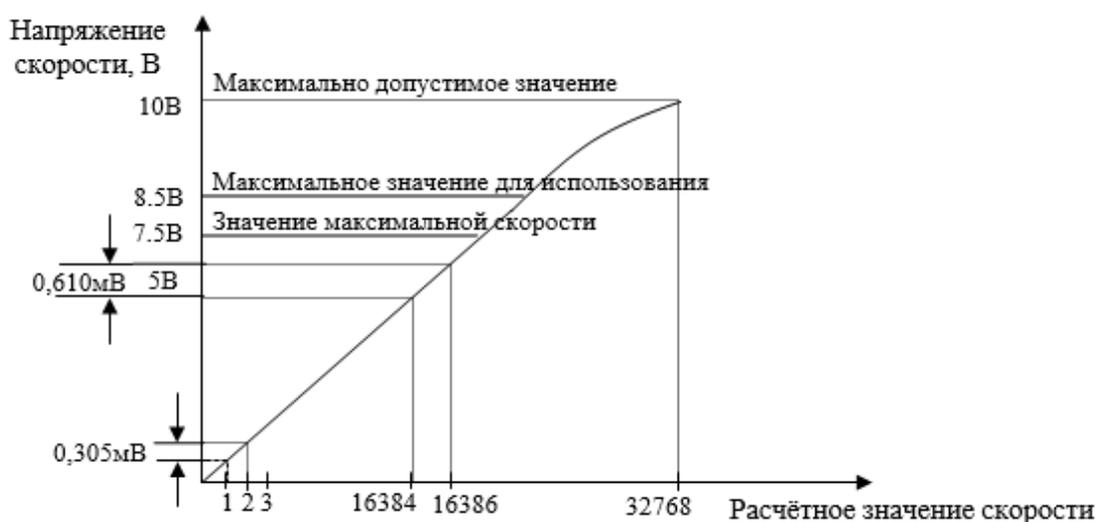
Рисунок 4 - График выходного напряжения ЦАП (16 разр.) [1]
