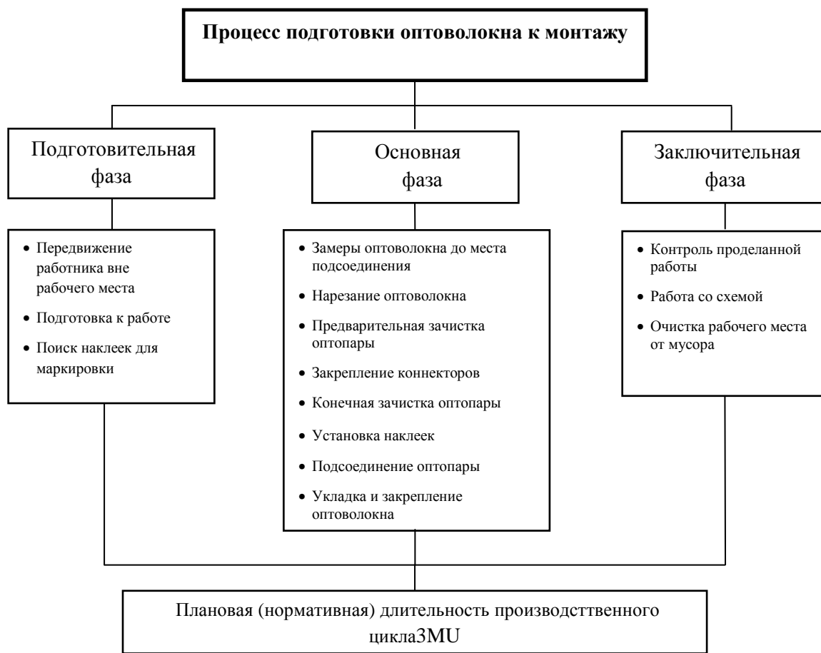
Рисунок 2. Процесс подготовки оптического волокна к монтажу Источник: составлено автором
