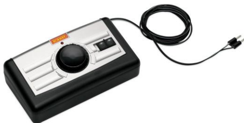
Рисунок 1.2. Аналоговый блок управления компании Hornby
