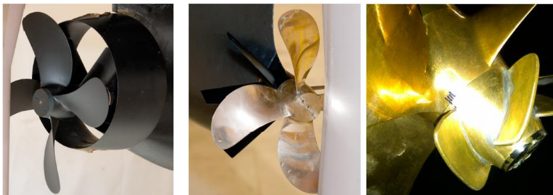
Joonis 5. Tugilabaga tunnel, statsionaarsed labad ja PBCF Allikas: (Dang, et al., 2011)
