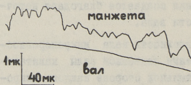
Фиг. 1. Контактные поверхности вала и манжеты по периметру после 30 часов совместной работы.
