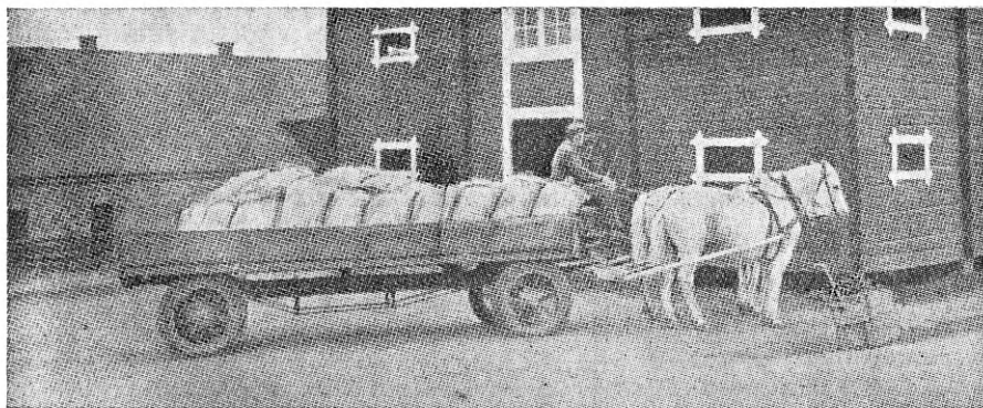
Pilt 8. Kahehobuse taluvanker (ehitatud vanast autošassiist) 3000 kg koormaga.
