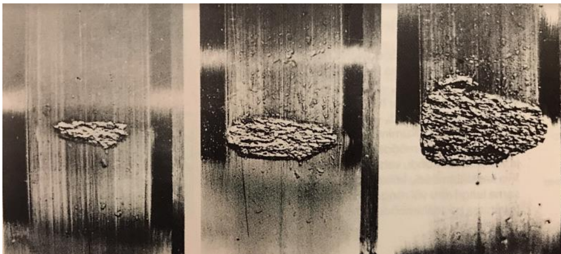
Joonis 3.2. Materjali väsimuse järkjärgulised etapid laagripinnal [38]
