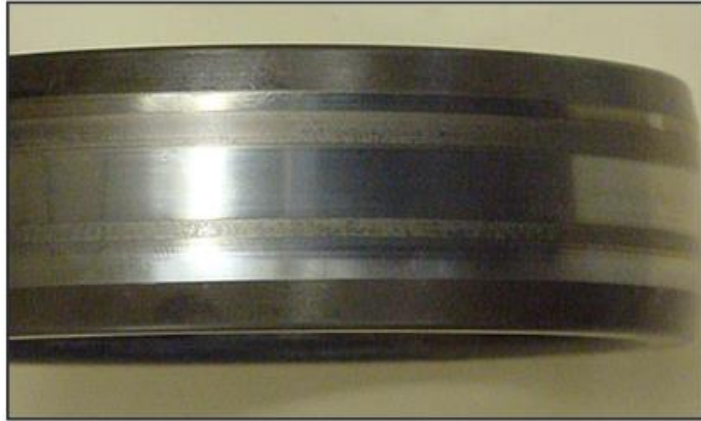
Joonis 3.8 “Dull-finish” ja kraatrid laagri sisevõrul [44]
