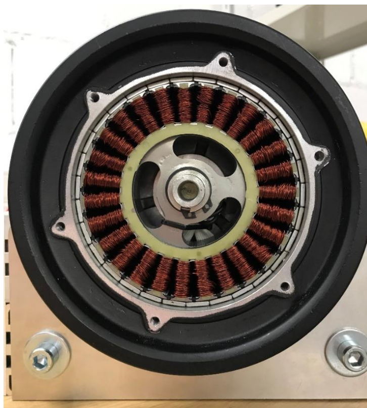
Joonis 1.4. Harjavaba alalisvoolumootori staator
