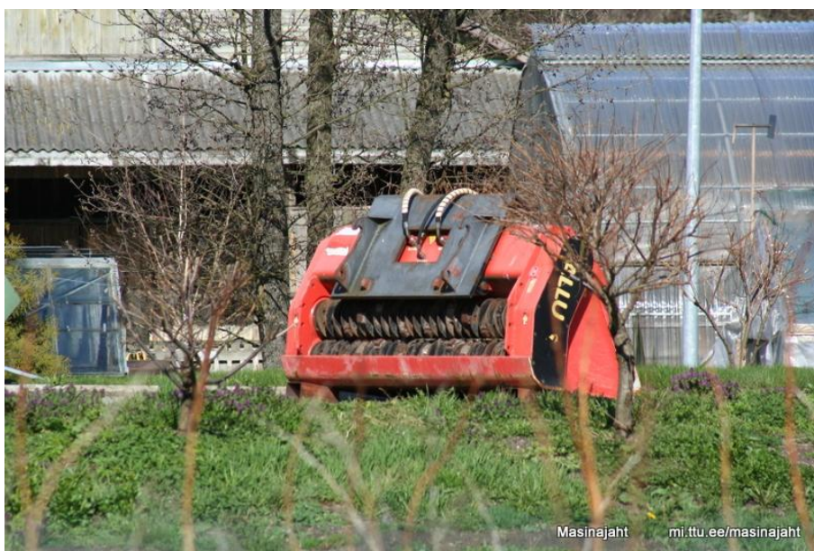
Joonis 1-17 Võll-sõelpurustiga kopp
