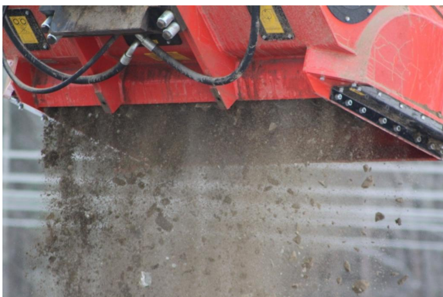
Joonis 1-19 Võllpurusti koorib lubjakivitükkide küljest põlevkivi
