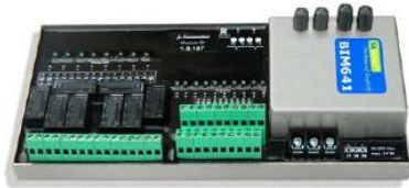
Joonis 3.3. BIM-i vaade ülevalt. Paremäl ülansurgas on kaks optika porti, all paremal on toiteklemmid, keskel 10 DI, vasakul 8 DO.[33]
