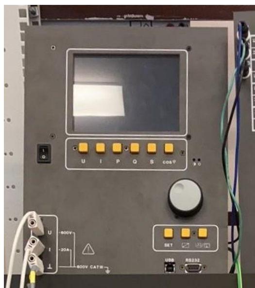
Рисунок 2.6 Аналого-цифровой мультиметр, измеритель мощности и косинуса фи SO5127-1Z
