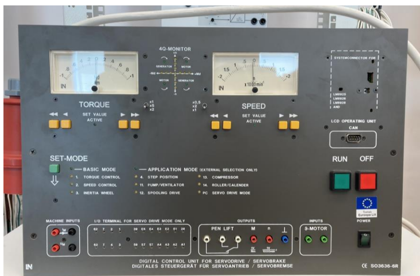
Рисунок 2.2 Комплексное управляющее устройство для сервомотора SO3636-6R
