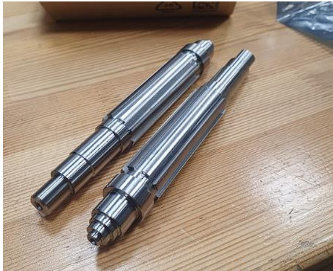
Joonis 2.12. Titaansulamist elektrimootori võllid enne Saksamaa tehasesse saatmist
