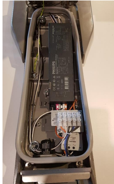
Joonis 2.23. Valgusti draiver (must), liigpingepiirik (valge) ja kaabli ühendusklemmid
