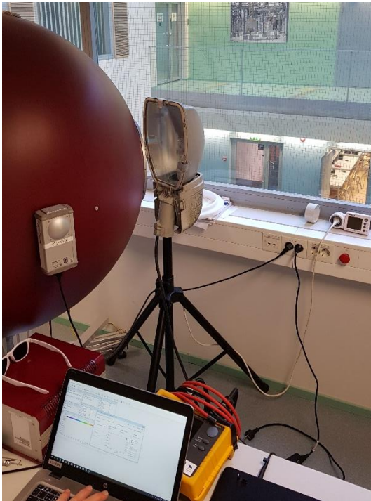
Joonis 2.4. Valgustite kinnitamiseks vajalik reguleeritav staativ
