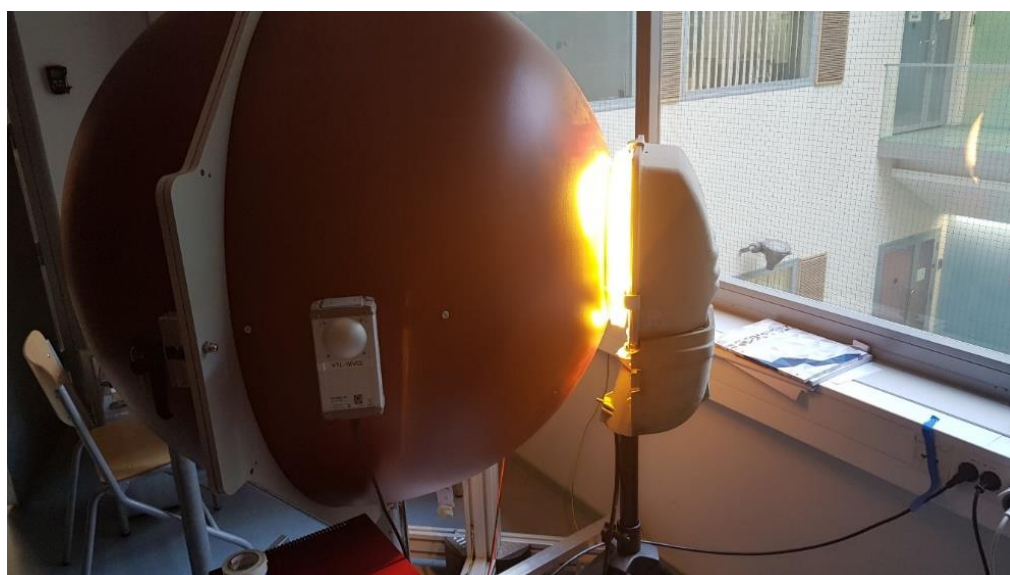
Joonis 2.3. Valgusti Myra reflektor ja klaas olid fotomeetrilise kuuli ava jaoks liiga suured ja seetõttu läks osa valgusvoost kaduma
