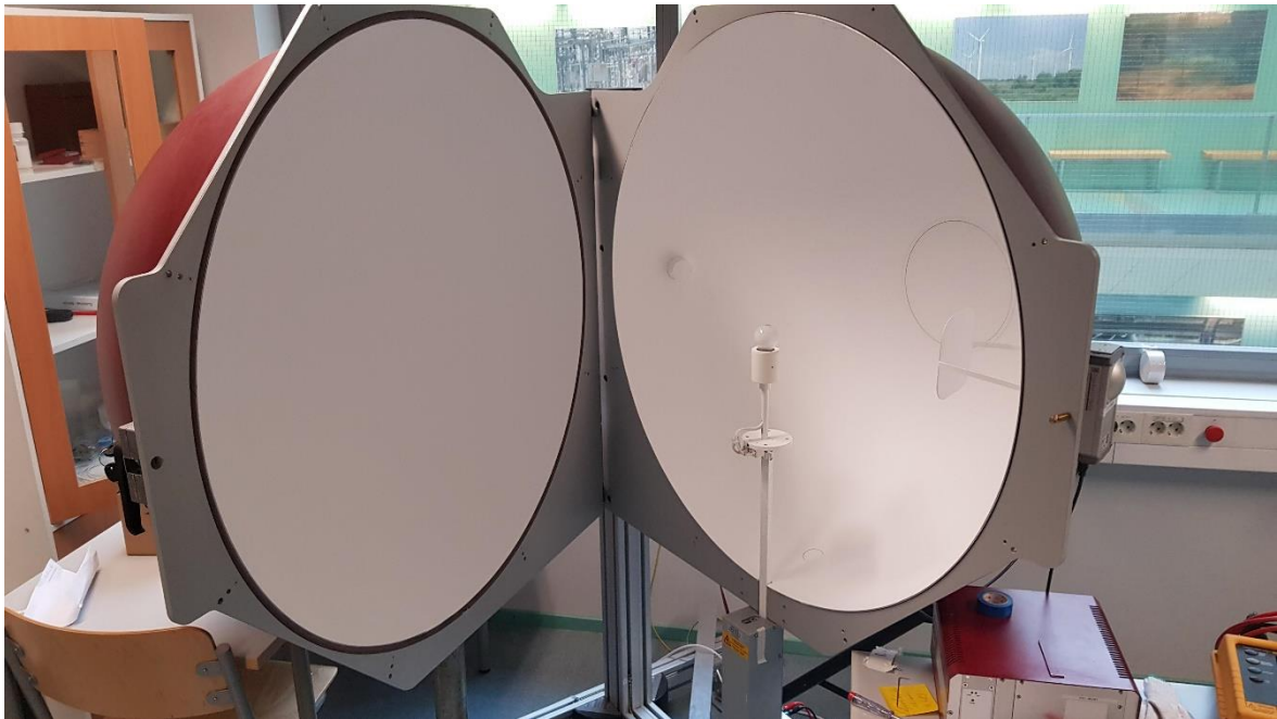
Joonis 2.1. Ulbrichti kuul valgusallikaga
