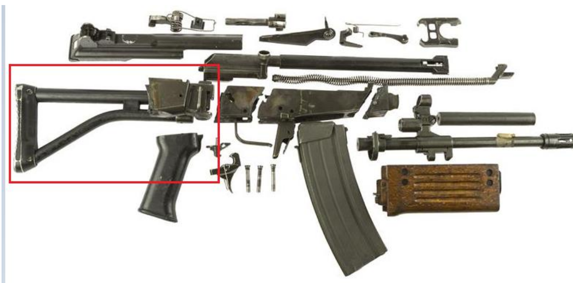
Joonis 8. Galil AR relva tagaosa on modifitseeritav, tuleb vaid säilitada kinnitused [10]
