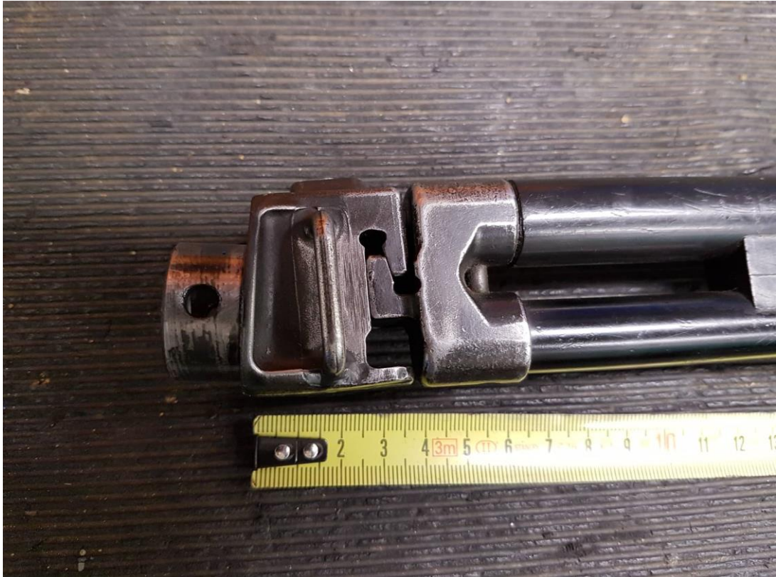
Joonis 36. Torude klambri sisse mineva osa mõõt
