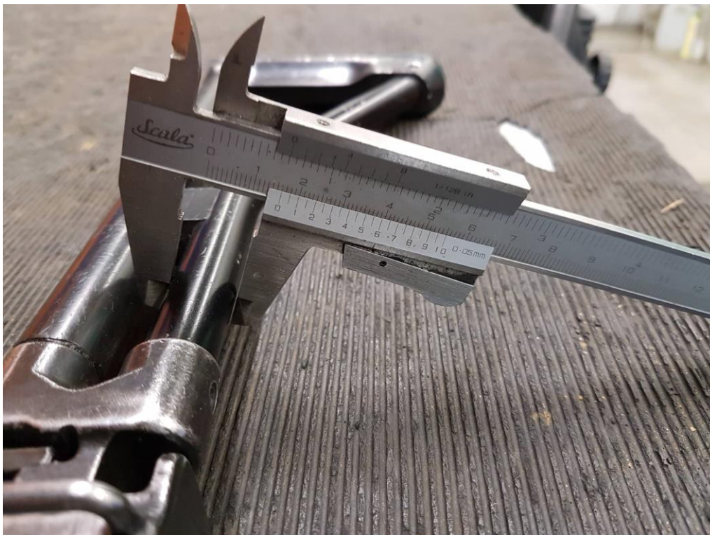
Joonis 34. Relva tagaosa alumise toru läbimõõt
