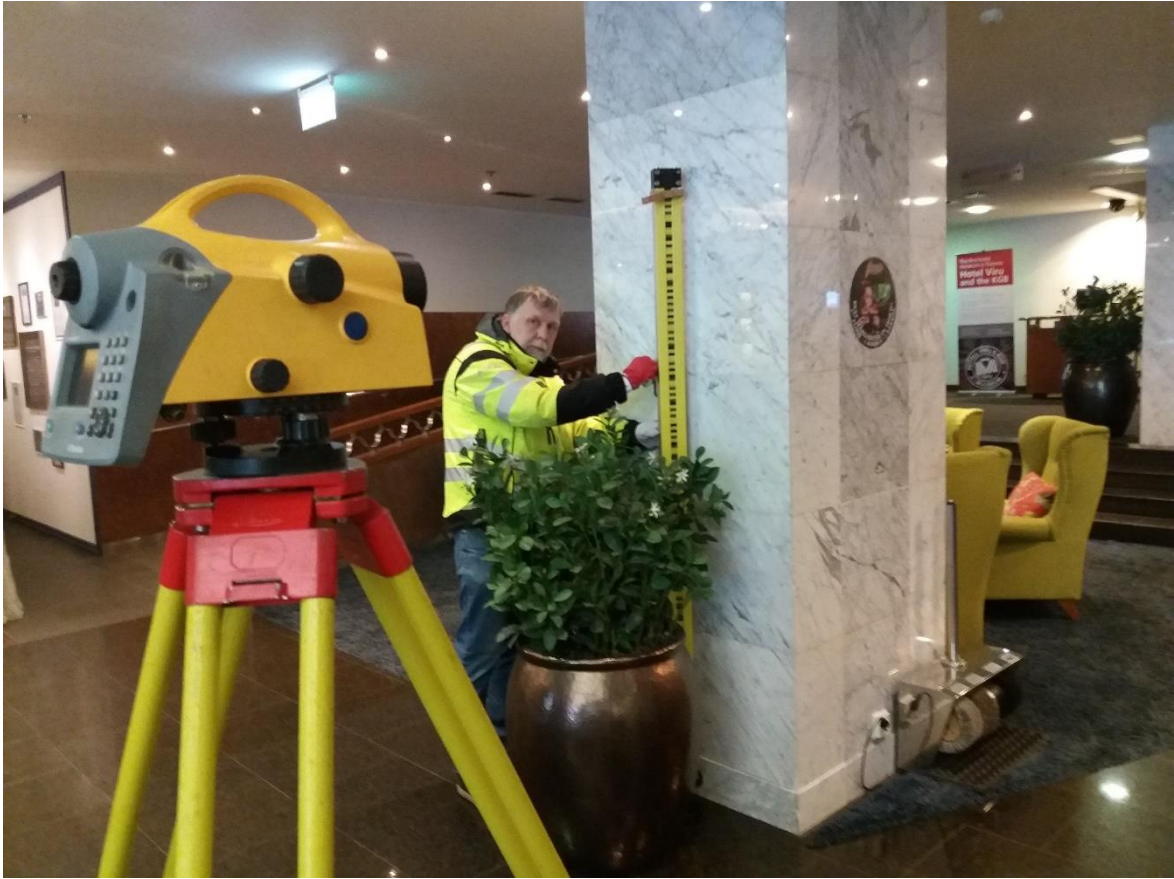
Joonis 8.3 Trimble DiNi 0.3 koos invarvötkoodlatiga Viru fuajees paikneva reeperi R42 juures.
