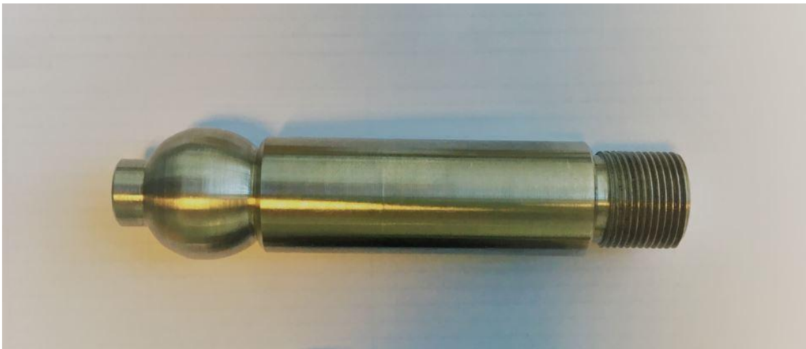
Joonis 6.13 Viru keskuse ja hotelli kandvate postide külge paigaldatud reeperitüüp. Roostevabast terasest ümara peaga M22x130. [14]
