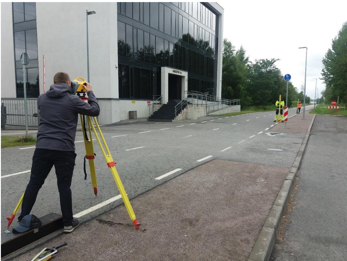
Joonis 8.4 Nivelliiri kontrollimine Näbaueri meetodil.
