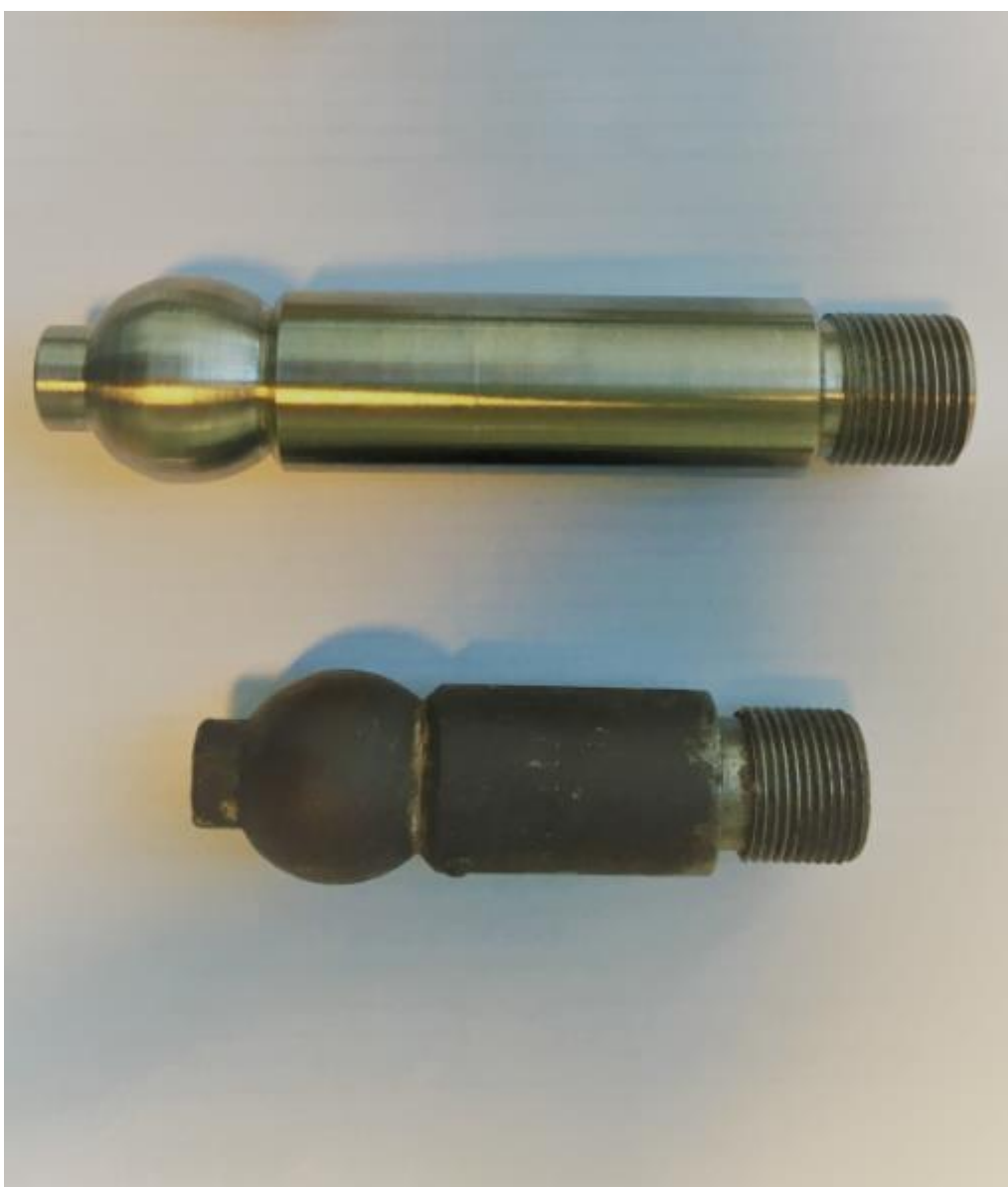
Joonis 3.2 Hotelli fuajees välja vahetatud vajumisreeper (üleval) ning vana reeper, mis jäi hoone renoveerimistöde käigus lühikeseks (all).
