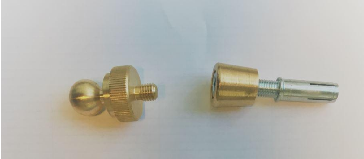
Joonis 6.12 Viru keskuse ja hotelli kandvate postide külge paigaldatud reeperitüüp. Messingust peaga M8x22. [14]
