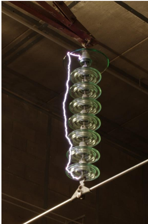
Joonis 5.3 Isolaatorkett 1 U120AD + 7 U70BL, kus 1 - U-polt, 2 - U120AD isolaator, 3 - U70BL isolaator, 4 - pesaplaat, 5 - kandeklemm.
