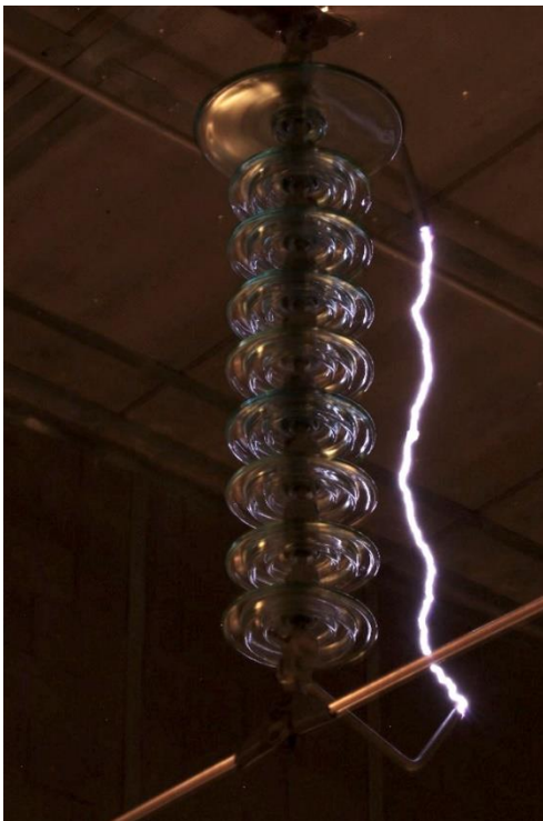
Joonis 5.13 Isolaatorkett 1 U120AD + 8 U70BS + sädevahemiku sarved kus, 1 – kinnitussõlm, 2 – sädevahemik, 3 – U120AD isolaator, 4 – U70BS, 5 – pesaplaat, 6 – kandeklemm.
