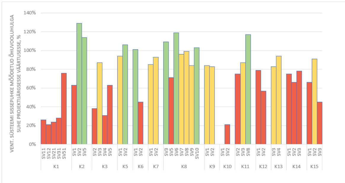
Joonis 5.1 Mõõdetud sissepuhke õhuvooluhulkade suhe projektijärgsesse väärtusesse, koolide ja ventilatsioonisüsteemide kaupa
