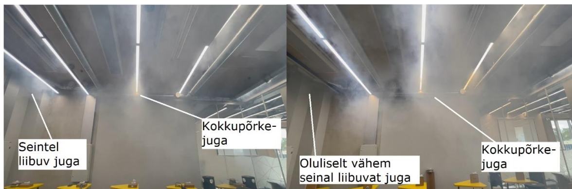
Joonis 5.14 Tossu jaotus katsel 3.1 ( \Delta t \approx 4^\circ\text{C} ) (vasakul) ning katsel 3.2 ( \Delta t \approx 0^\circ\text{C} ) (paremal)
