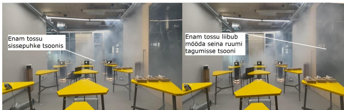
Joonis 5.6 Katsete 1.1 ( \Delta t \approx 4^\circ\text{C} ) (vasakul) ja 1.2 ( \Delta t \approx 0^\circ\text{C} ) (paremal) tossukatsete kuvatõmmised
