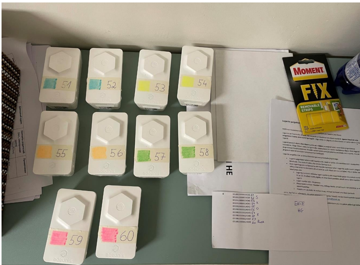
Joonis 4.2 Adeunis CO 2 mõõteseadmete markeritud komplekt auditeeritud koolis
