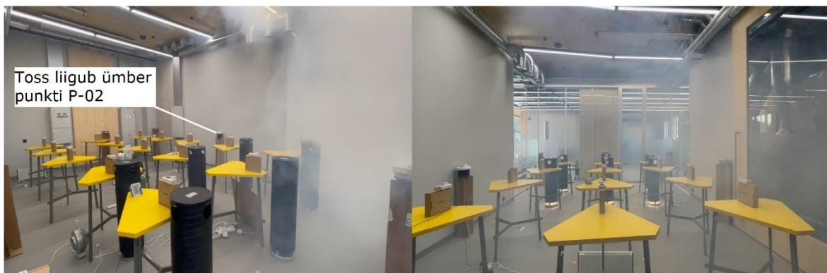
Joonis 5.10 Plafoonidega katsel isoleeritud loger P-02 (vasakul), tossu ühtlane jaotus (paremal)
