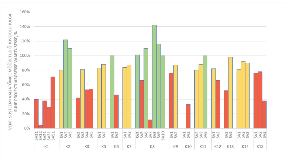
Joonis 5.2 Mõõdetud väljatõmbe õhuvooluhulkade suhe projektijärgsesse väärtusesse, koolide ja ventilatsioonisüsteemide kaupa
