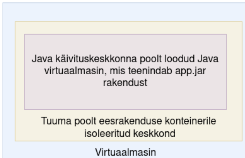
Joonis 5. Konteineriseeritud tagarakenduse paiknemine virtuaalmasinas.
