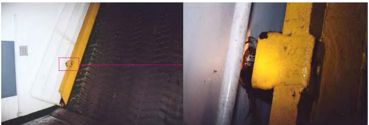
Joonis 3. Estoniaga identse vöörirambi lukustusüsteemiga parvlaeva Mare Balticum rambi külgluku riiv ja selle pesa (kollane karp) ning nende kohal paiknev rambi alumine reelingubarb (valge). Rambi avanedes tungis lukustusriiv läbi pesa pealmise osa ning tõmbas seejärel küljest rambi reelingu.
