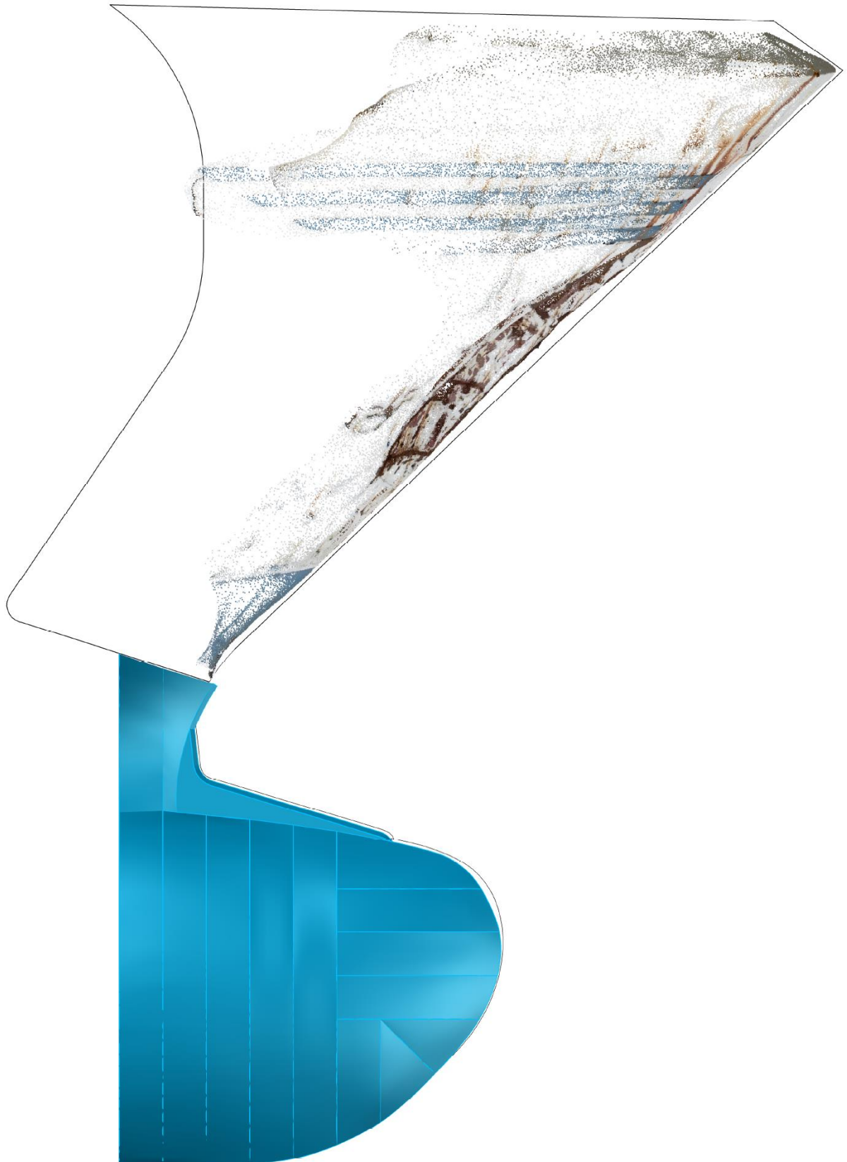
Joonis L5-2. Parvlaeva Estonia vöörivisiiri fotogramm-meetrilise punktipilve ja pinnvööri kolmemõõtmelise mudeli külgvaade ning Estonia üldjoonise visiiri ja pinnvööri kontuur mudelite mastaabi kontrolliks programmis AutoCAD
