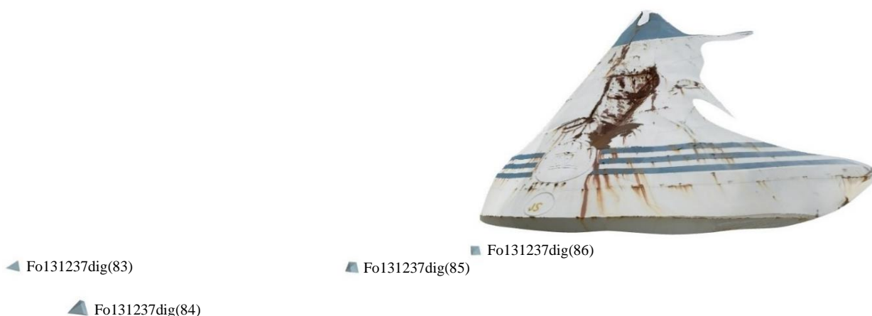
Joonis 1. Estonia visiiri esikülje mõlgi ja teiste vigastuste modelleerimiseks kasutatud fotode (Fo131237dig[N]) automaatselt tuvastatud asukohad rakenduses ReCap Photo Kasutatud fotode allikas: Maria Ljunggren / Sjöhistoriska museet. Kasutatud fotod ja nende töötlemisel saadud kujutis on avaldatud litsentsi CC BY-SA 4.0 alusel
