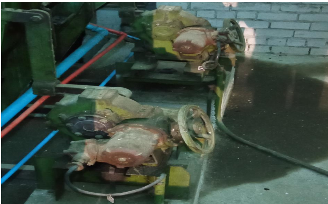
Lisa Joonis 8 juhtlaba reguleerimismehhanism
