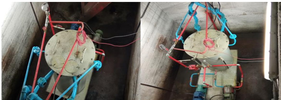
Joonis 1.6 VTK-30 õlitusjaam Estonia kaevanduses
