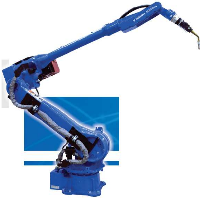
Sele 3.11. Keevitusrobot Yaskawa Motoman MA3100[10]
