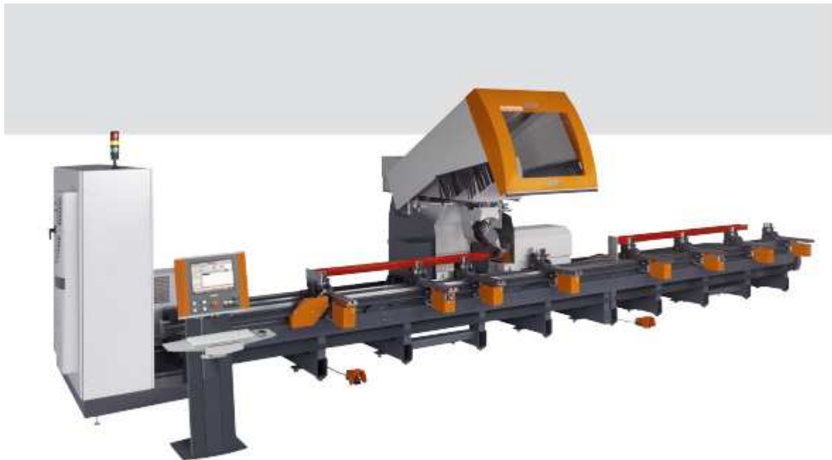
Sele 3.9. Elumetec profiiltöötluskeskus SBZ150 [7]
