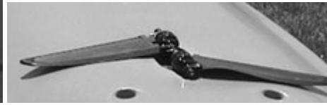
Fig. 30. Hobie Cat fin propulsion unit
