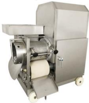
Joonis 3. Tööstuslik kalaliha separaator (ForFish, 2023)
