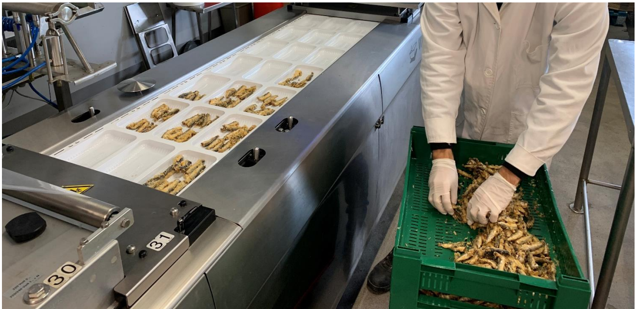
Joonis 25. Kalade pakendamine gaasikeskkonda.
