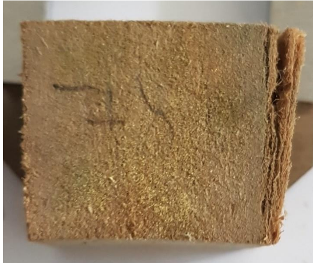
Joonis 10. 14 päeva 95% õhuniiskuse ja 23°C temperatuuri juures olnud katsekeha, kus parem serv kuivamiskahanemisel lahti rebestunud
