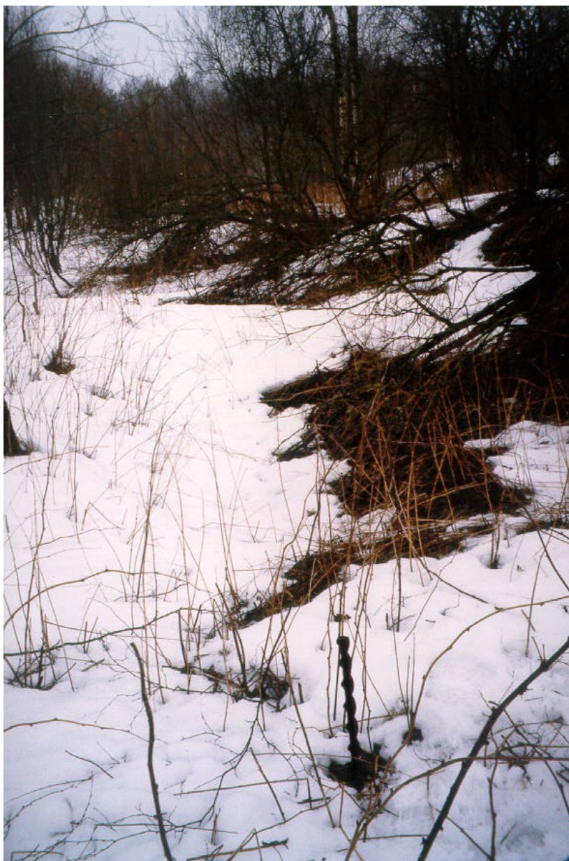
Joonis_2.38 Sügav varingulohk ja katsetööde jäljed Tammiku kaevanduse lausväljamise alal 2000. a kevadtalvel. Esiplaanil puurvardast pinnareeper. I. Valgma foto; X 6581403; Y 689783
