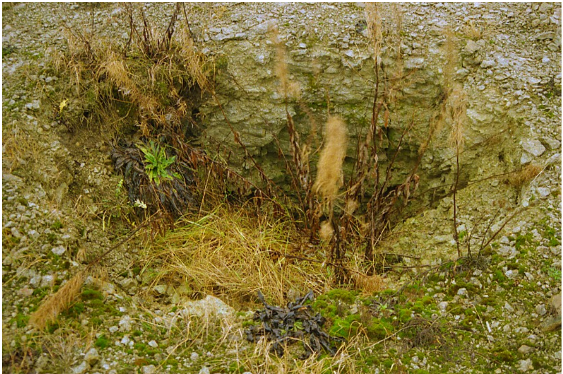
Joonis_2.32 Sillamäe uraanikaevanduse käigu varing E. Niitlaane foto; 2003; X 6591364; Y 711591 Võimalik, et kunagise tuulutuspuraugu jälg.
