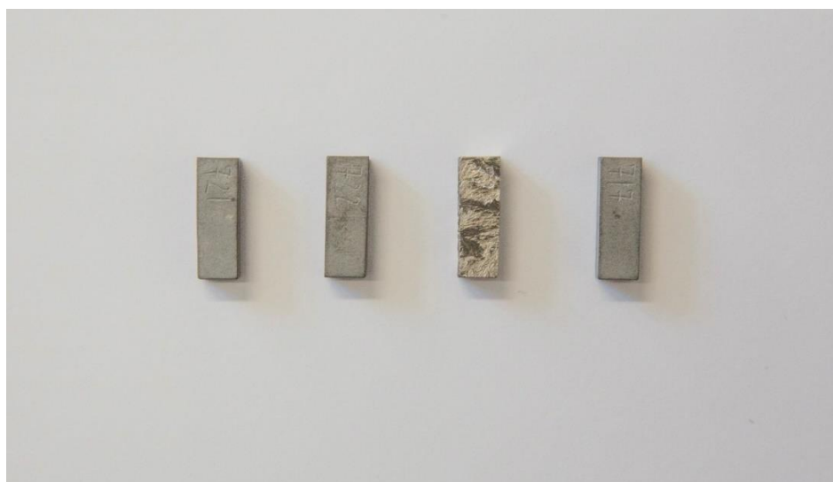
Sele 4.17. Katsekehad, mis on paagutatud temperatuuril 1425 °C
