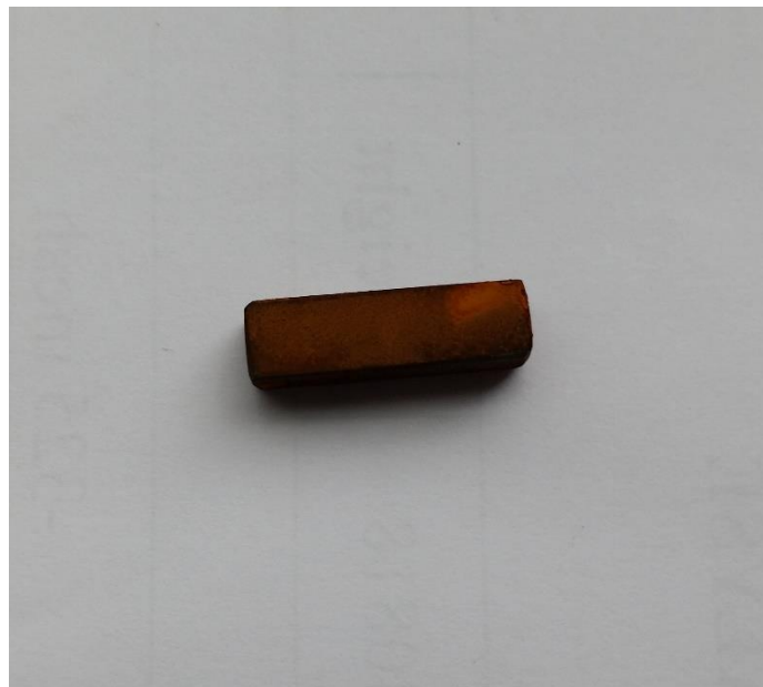
Sele 4.11. Korrodeerunud katsekeha pärast 72 tunnist soolalahust
