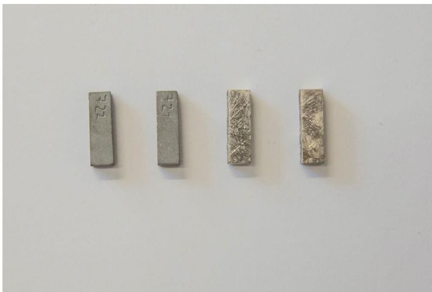
Sele 4.18. Katsekehad, mis on paagutatud temperatuuril 1375 °C
