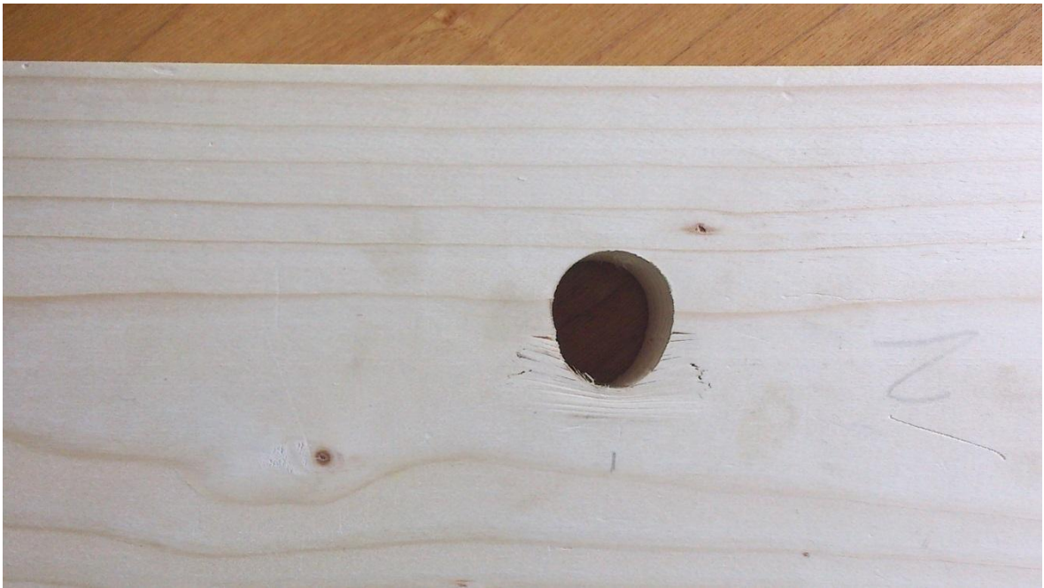
Joonis L4.3. Alusmaterjali tapipesa ristikiudu muljumine
