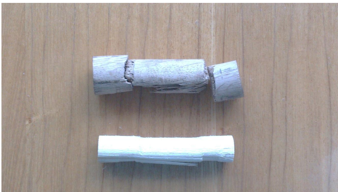
Joonis L4.2. Katse käigus purunenud naaglid
