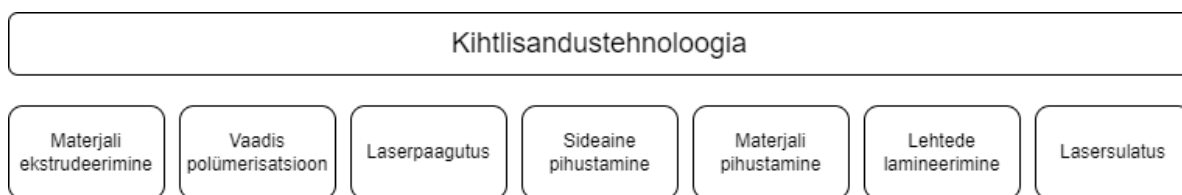
Joonis 1. ISO/ASTM 52900 standardis klassifitseeritud 3D printimise protsessid [10]
