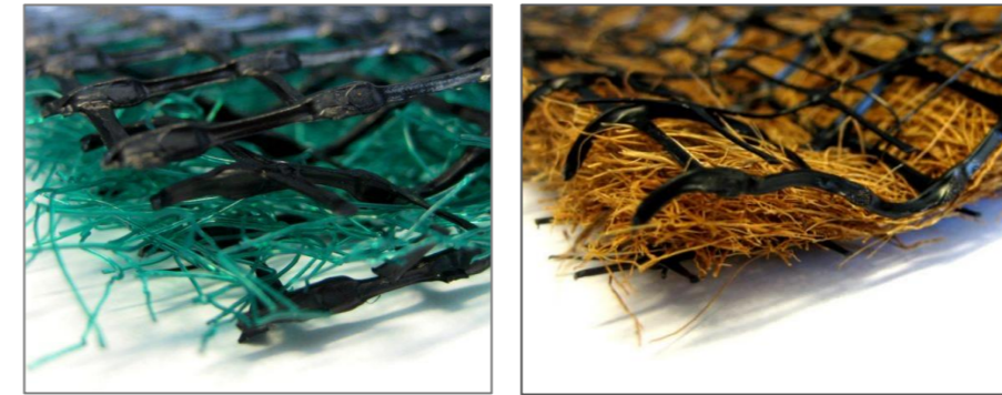
Joonis 3.16 Näide 100% sünteetilisest geomatist (vasakul) ja kombineeritud biolagunevast ja püsivast materjalist geomatist (paremal)
