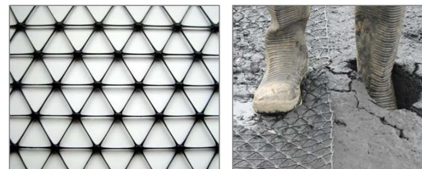
Joonis 3.13 Kolmesuunaline geovõrk(vasakul) ja näide selle kasutamisest pinnase tugevdamisel (paremal).
