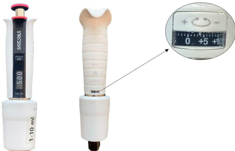
Joonis 3.8 Mõõtevea seadistamine peale pipeti kalibreerimist
