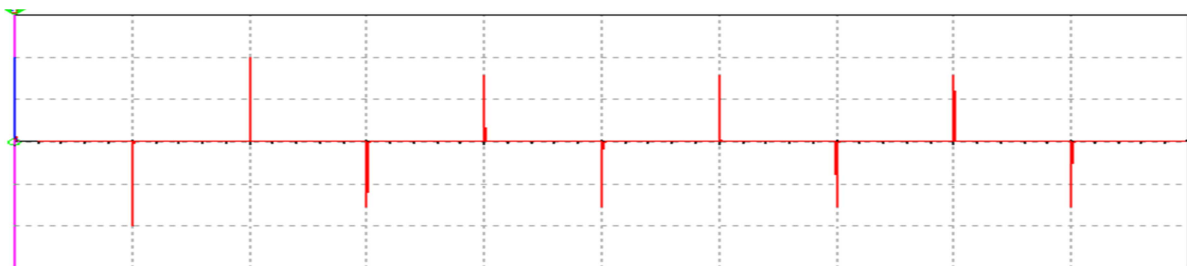
Joonis 2.12 Kõrgpääsfiltri väljundsignaal madalal sagedusel
