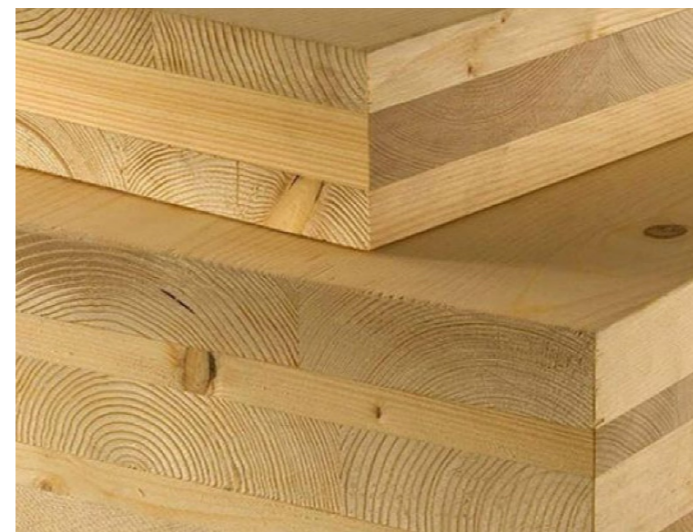
Joonis 9 – CLT materjal. Allikas: https://cltbuildings.ee/clt-puit/
