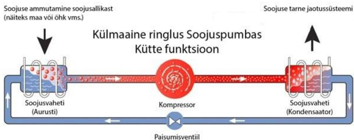
Joonis 4. Külmaaine ringlus soojuspumbas [17]
