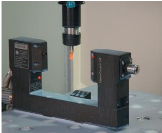
Sele 4.38 Lõikurite kulumise mõõtmiseks kasutatakse tööpingis näiteks Blumi mõõtelaserit LaserControl NT-H.
