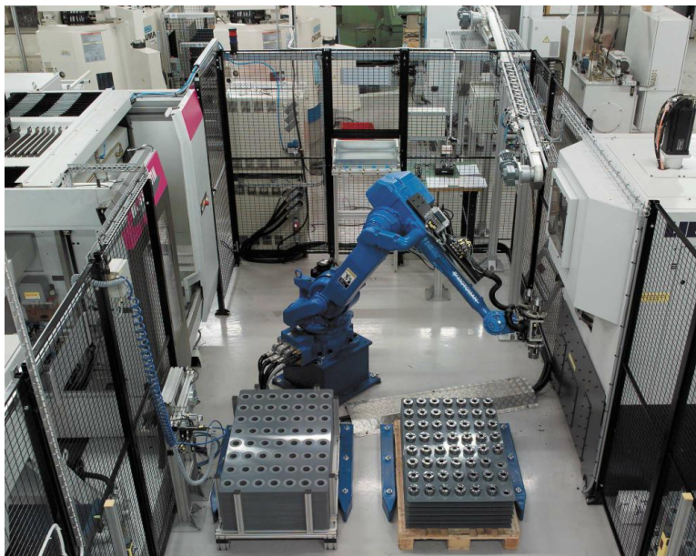
Sele 4.56 Robotiseeritud süsteemi asendiplaan (Motomani näide)
