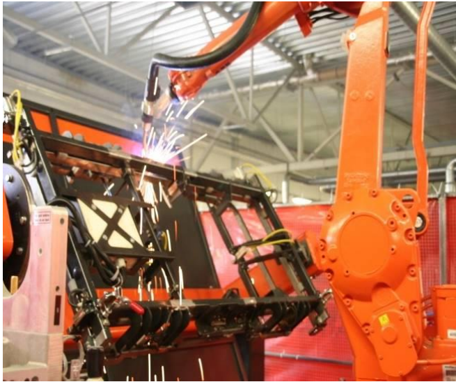
Sele 4.57 Keevitusroboti kasutusnäide
