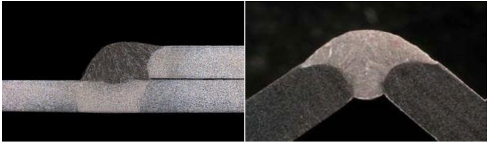
Sele 5.30 WiseThin meetodiga saavutatakse madal soojussisestus ja optimaalne keevisõmbuluse geometria. Materjali paksus 1,0 mm [5.13]
