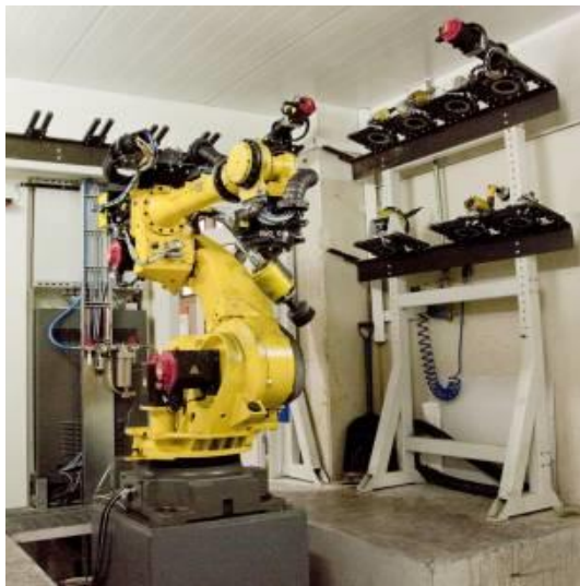
Sele 4.61 Tööriistade automatiseeritud vahetus robotsüsteemis (Fastemsi lahendus)
