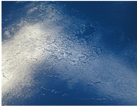
Sele 5.115 Alkүүdvärv on tõmbunud kortsu, kuna ülevärvimise aeg on vale
