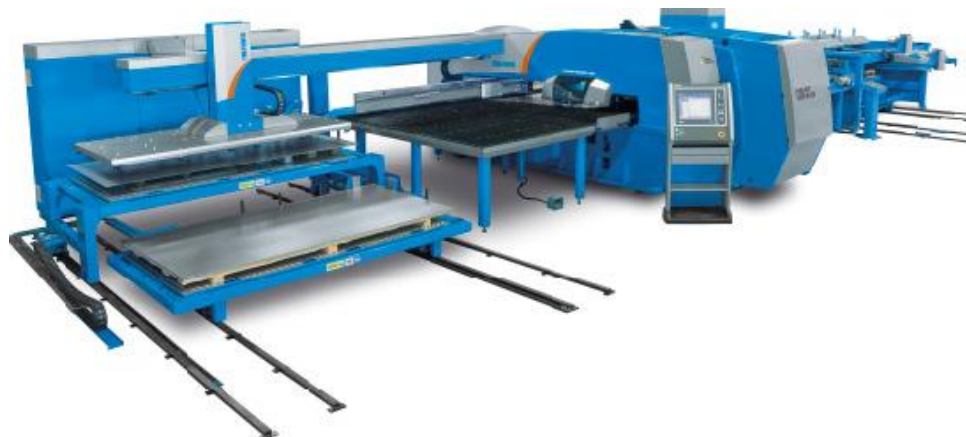
Sele 4.24 Lehtmaterjalide töötlemise süsteem (Prima Power Oy)
