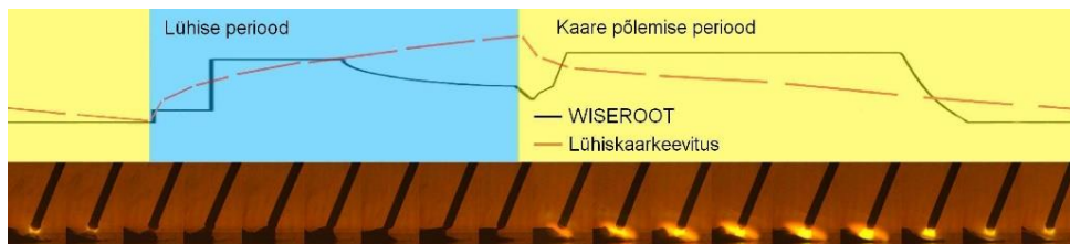
Sele 5.28 Voolu muutused lisamaterjali siirdumise eri etappidel WiseRoot meetodil
