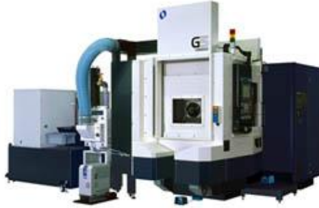
Sele 4.17 Makino 5-teljeline mitmeotstarbeline töötlemiskeskus G5
