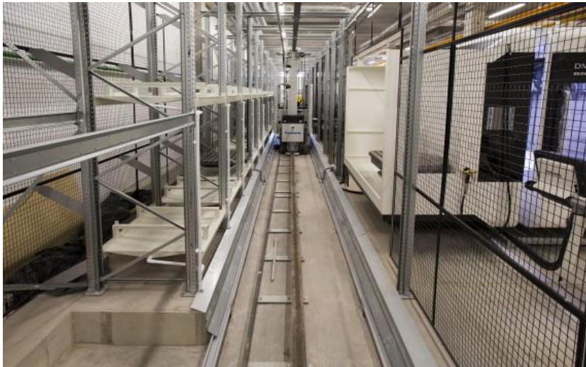
Sele 4.36 Automatiseeritud ladu (Mehhatroonikum)
