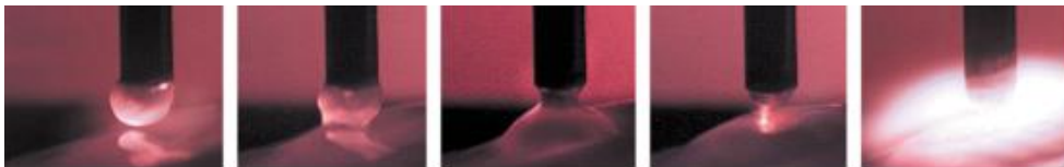
Sele 5.27 Kiir-kaamera pildid lisamaterjali siirdumisest STT-meetodil
