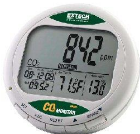
Joonis 7. Extech EXCO 210 andmeloger[15]
