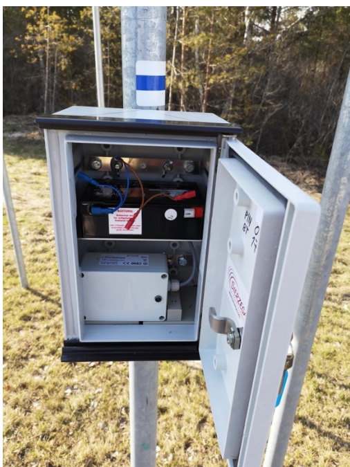
Joonis 11. Mõõteseadme. Ülemine osa on aku ja alumine karp on andur Allikas: Autori foto
