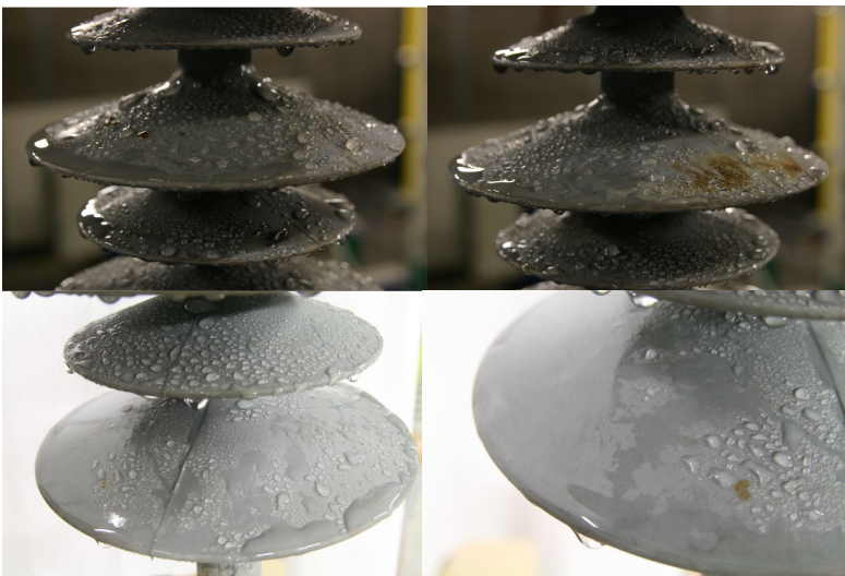
Joonis 5.6 Seeliku osaline hüdrofoobsuse kaotus .
