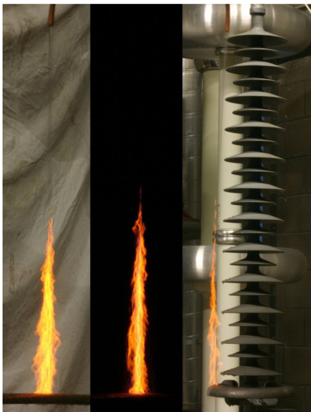
Joonis 5.27 Jugalahendus pritsi – faasijuhi ja pritsi – väljäuhtlustusrõnga vahel.
