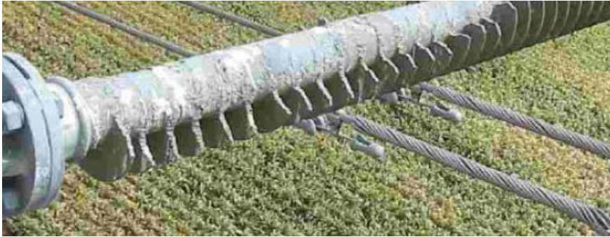
Joonis 6.11 Lindude poolt kahjustatud horisontaalasetusega komposiitisolaator [48].
