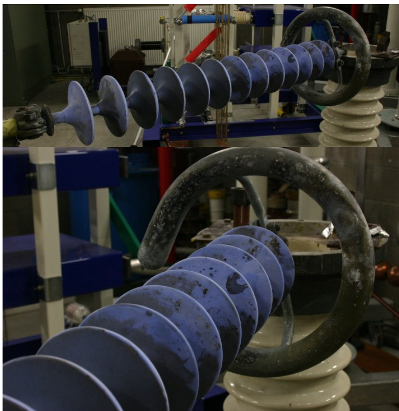
Joonis 5.8 Seelikupinna saastumine, kaarekahjustused. Kaare jäljed väljajühtlustusrõngal.
