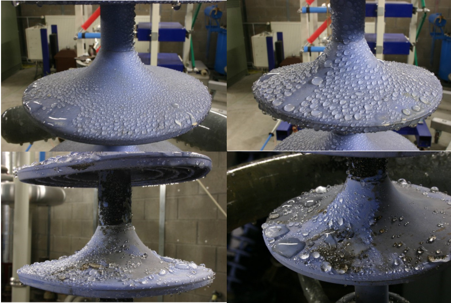
Joonis 5.12 Seeliku osaline hüdrofoobsuse halvenemine kahjustunud pinnal. Saastunud pind endiselt hüdrofoobne (tumedam pind).
