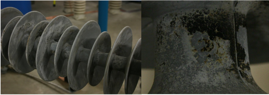
Joonis 5.4 Seelikupinna saastumine, kahjustumine lahenduste ja osalahenduste tõttu.
