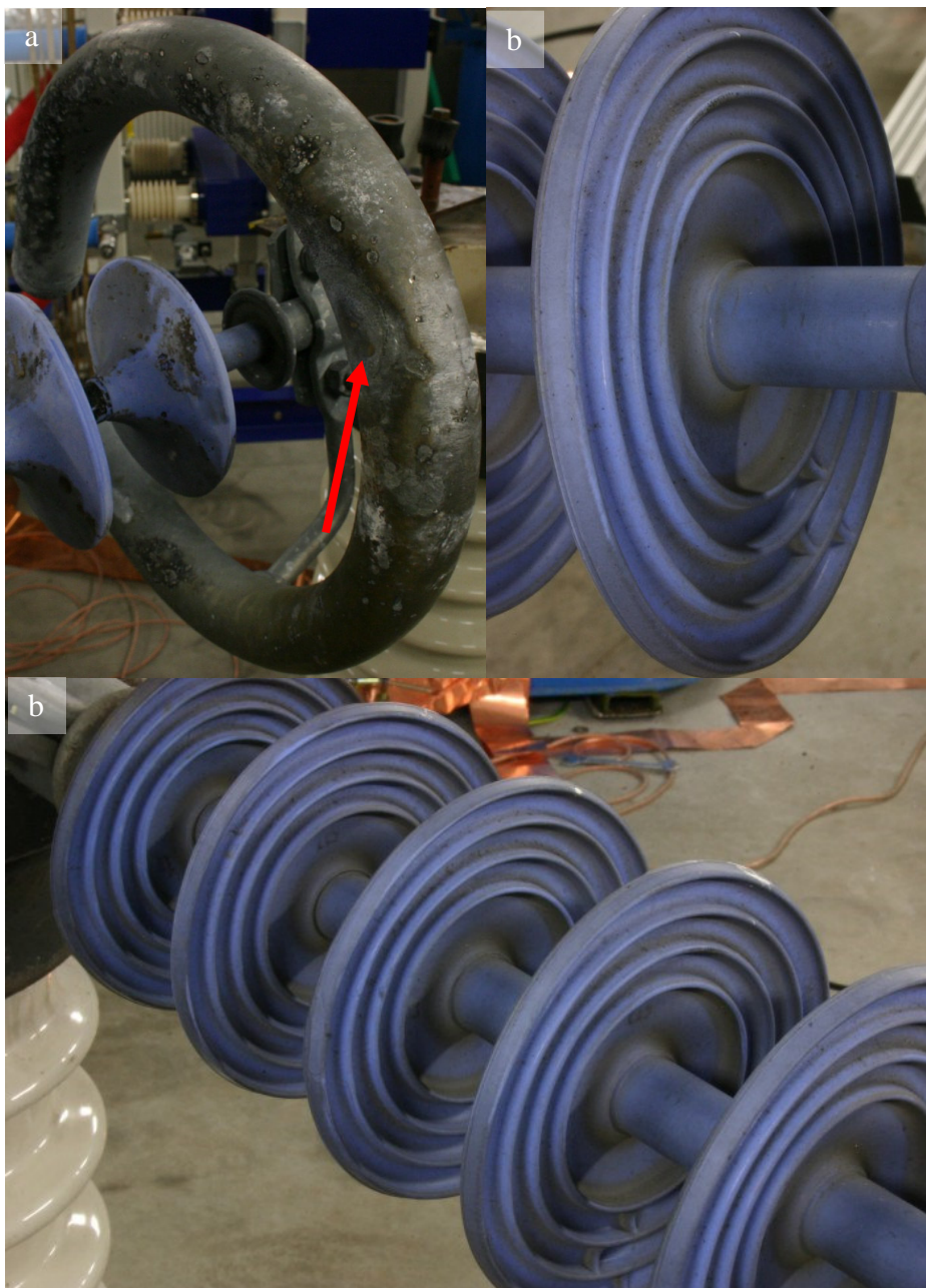
Joonis 5.11 a) kaare põhjustatud sulamise jäljed väljäuhtlustusrõngal, b) kaarest kahjustamata isolatori saastumine.
