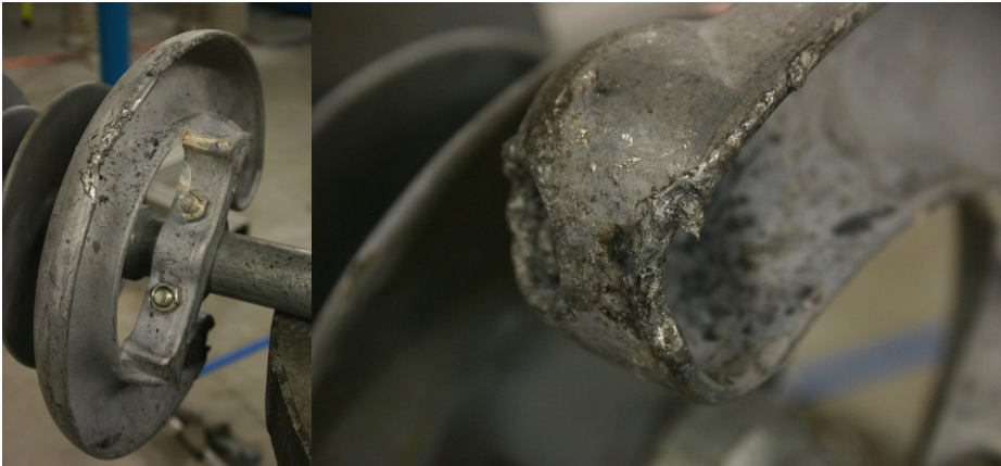
Joonis 5.5 Väljäähtlustusrõnga kaarekahjustused.
