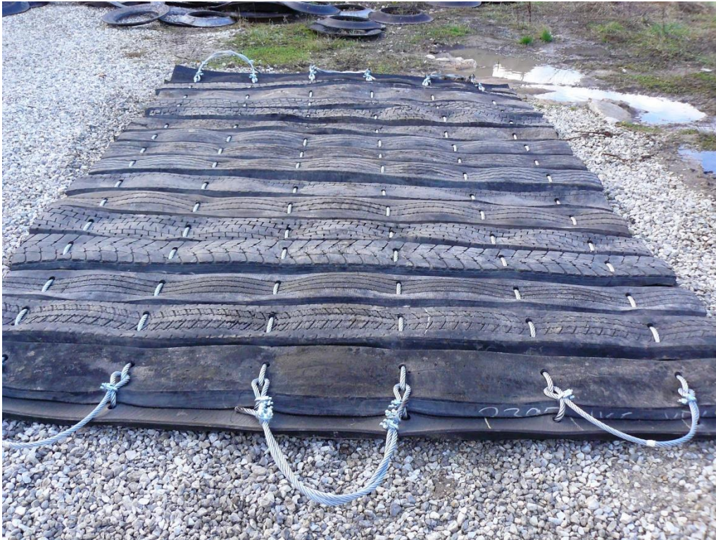
Joonis 10 Lõhkamiskoha kummimatt, mis on tehtud vanadest autorehvidest. Tegemist on spetsiaalse tellimustööga Päästeametile.
