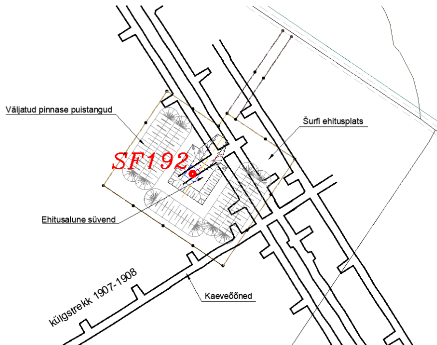
Joonis 16. Šurfi nr 192 asendiplaan
