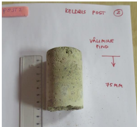
Foto 7. Karboniseerumise määramine postilt nr. 146, PR-02
