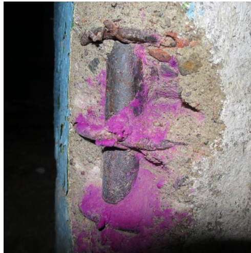
Foto 11. Karboniseerumise määramine raamipostil G, PR-06
