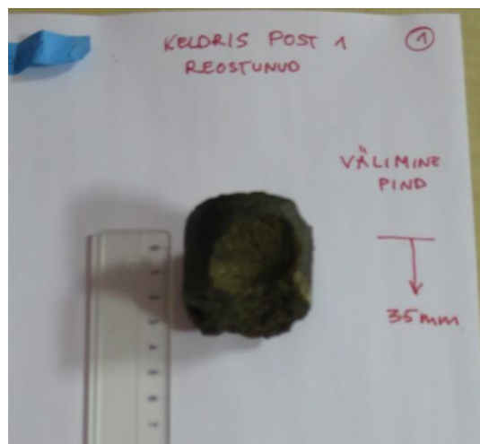
Foto 6. Karboniseerumise määramine postilt nr. 136, PR-01
