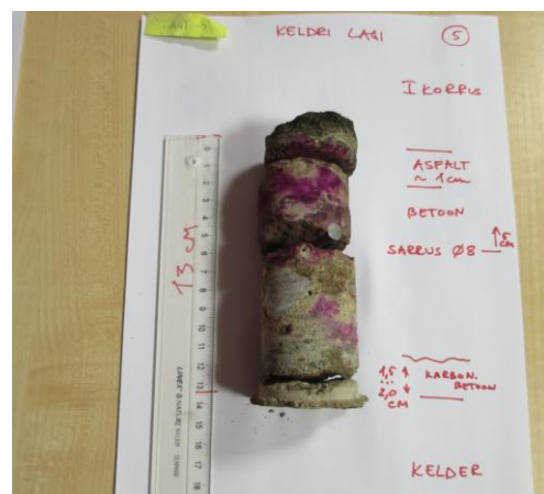
Foto 10. Karboniseerumise määramine vahelael, PR-05
