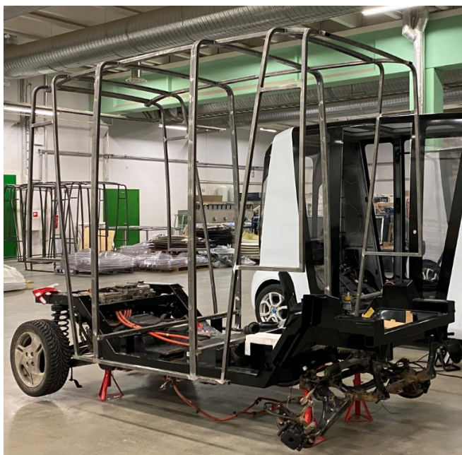
Sele 2.10 Iseauto valmis kereraam paigutatud alusraamil
