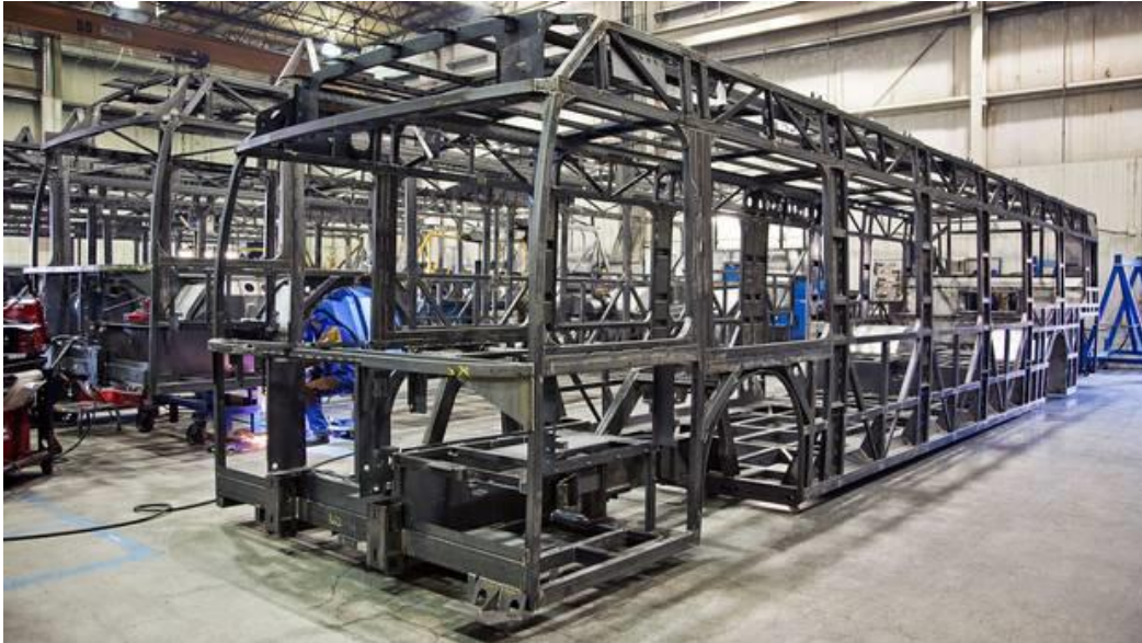
Sele 3.2 Bussi kereraami torukonstruktsioon [8]
