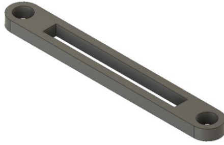
Joonis 3.3 Vallandamismehhanismi hoova aksonomeetriline vaade
